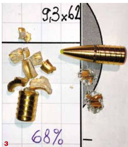
3 Kroglja O.K., kalibra 9,3 mm, trije strelji na tarčo, drobljenje krogle po strelu v papir.
