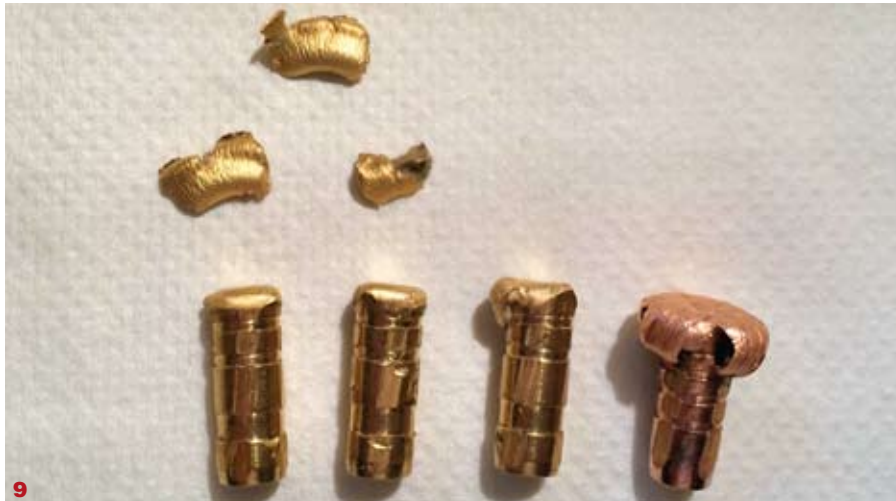
9 Avtorjev preizkus izstrelitve v moker papir; primerjava z Barnes TTSX , v 7,21 mm.
