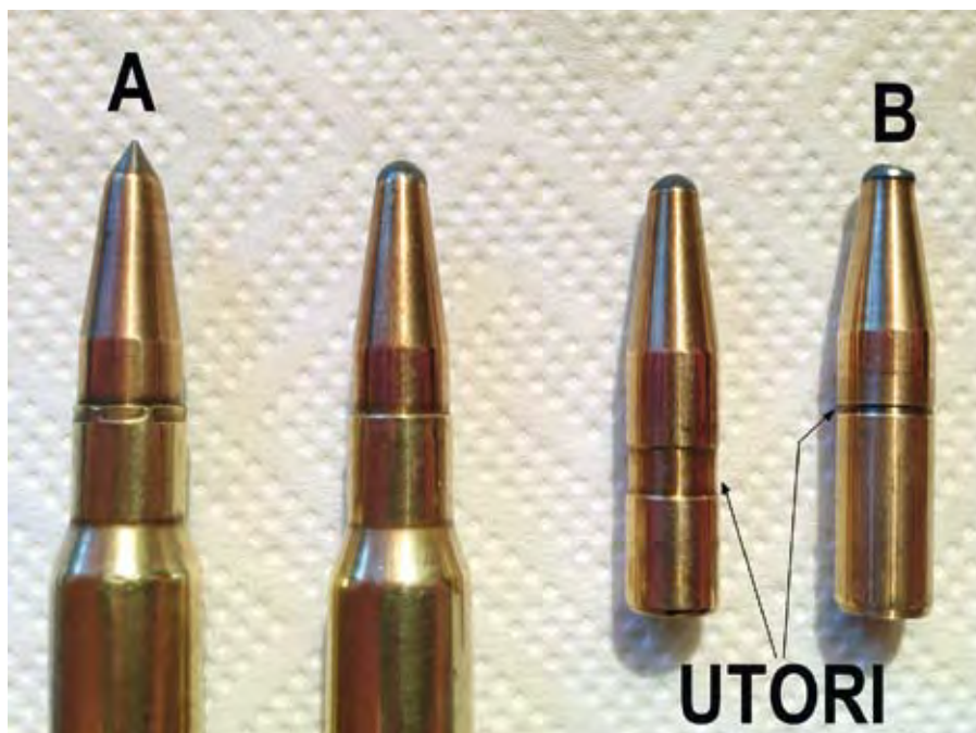
Sl. 6: Krogle ABC; prva na levi (6-A), vstavljena v tulec, je krogla ABC z jeklenim vložkom za lov velikega petelina; druga je običajna krogla ABC, vstavljena v tulec, tretja je krogla ABC z običajnim utorom na telesu krogle, namenjen zmanjšanju naležne površine, (6-B) zadnja pa je krogla ABC z ozkim (starejšim) utorom na telesu krogle, namenjen izključno zarobitvi tulca v telo krogle.
